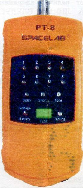
Тестер коаксиальных кабелей предназначен для поиска и идентификации коаксиальных кабелей. Это портативное устройство спроектировано для установщиков систем видео-наблюдения и кабельного телевидения сталкивающихся с необходимостью определения отдельных кабелей на кабельных трассах, терминированных F-разъемом.
